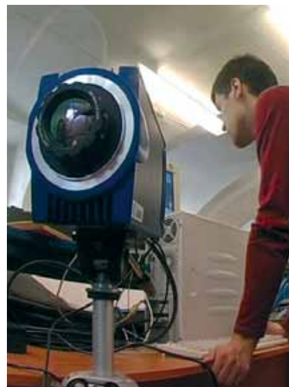
При эксперименте по моделированию природного пожара тепловизор Jade J530SB фиксирует тепловую картину огненного смерча
